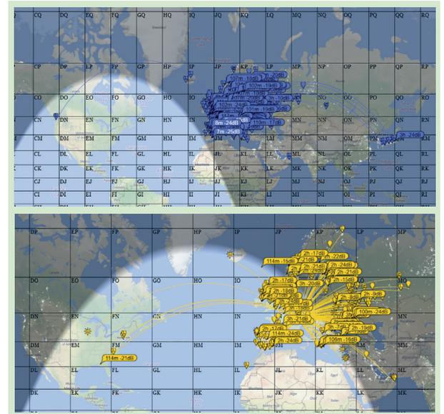
**Bild 15: Dokumentation von Betriebsversuchen mit der 65-cm-MLA in FT8 mit nur 4 W Sendeleistung. Einmal im 40-, einmal im 20-m-Band**
