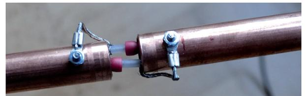
**Bild 7:** Nach Frequenzabgleich können die Koaxialkabel-Kondensatoren innerhalb der Rohre verstaut werden, wenn deren Innendurchmesser dies zulässt
