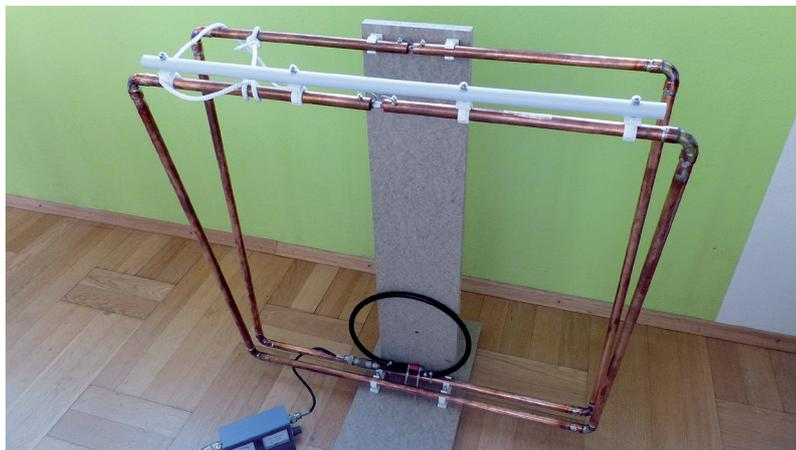
Die Loops werden aus Kupferrohren aufgebaut, wie sie für die Wasserinstallation Verwendung finden. Gängige Durchmesser sind 15, 18 und 22 mm.
